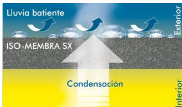
Principio de funcionamiento de la membrana de sellado
